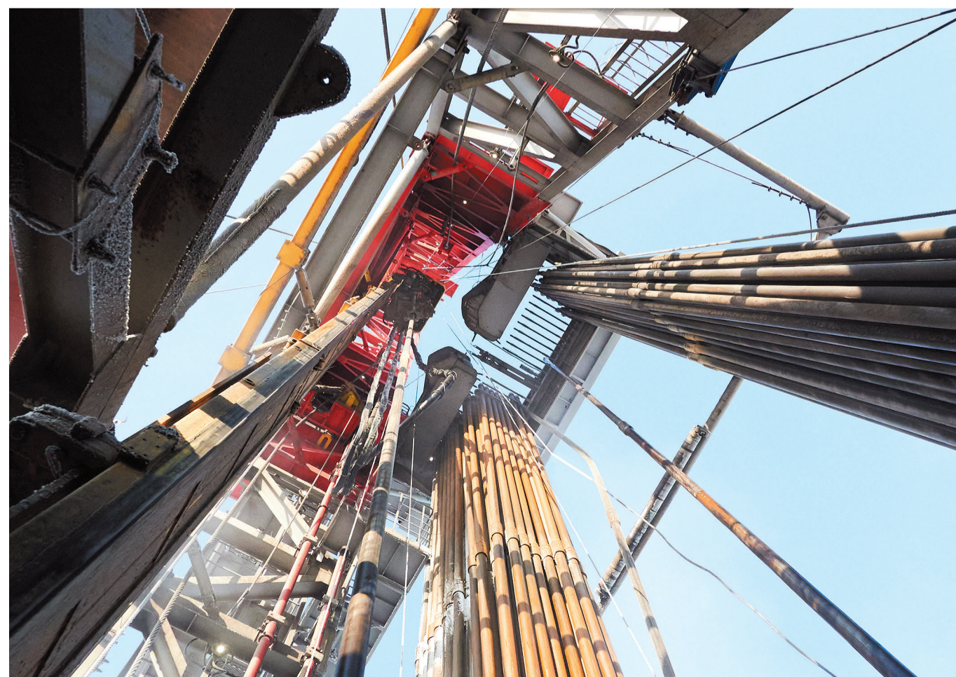
Верхний силовой привод буровой установки
